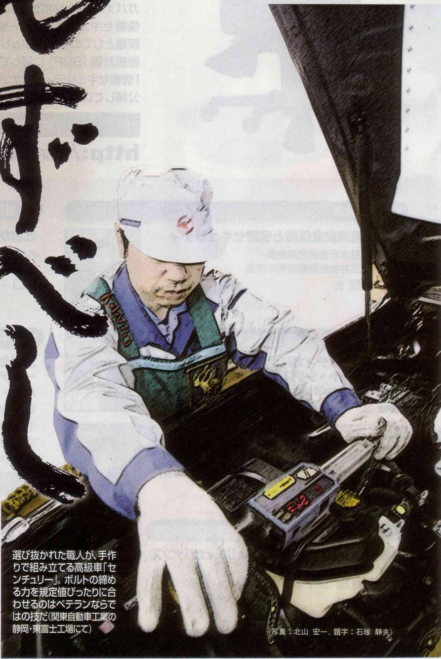
選び抜かれた職人が、手作りで組み立てる高級車「センチュリー」。ボルトの締める力を規定值ぴったりに合わせるのはベテランならではの技だ(関東自動車工業の静岡・東富士工場にて)
