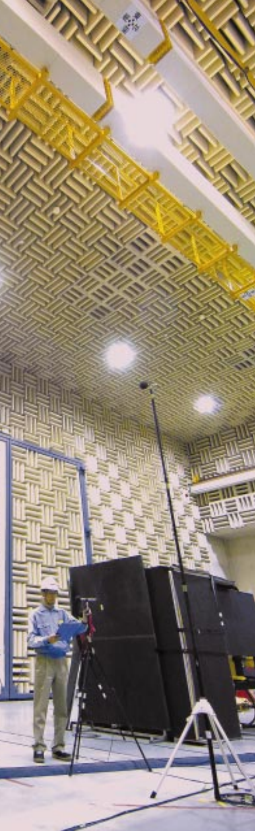
鉱山用の巨大なダンブトラックや油圧ショベルも丸ごと収まる無響音室。エンジンの周囲に8本の集音マイクを立てて音を計測する
